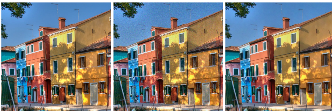
Obr. 2.11: Ukážka výsledku odstraňovania šumu nelokálnym priemerovaním z článku [5]. Naľavo je pôvodný obraz, uprostred obraz zašumený Gaussovským šumom a na pravo je obraz po aplikácii algoritmu. Všimnime si, že táto fotografia je veľmi vhodná na jeho nasadenie, pretože obsahuje veľa opakujúcich sa častí, priemerovaním medzi ktorými možno spoľahlivo odstrániť šum.
