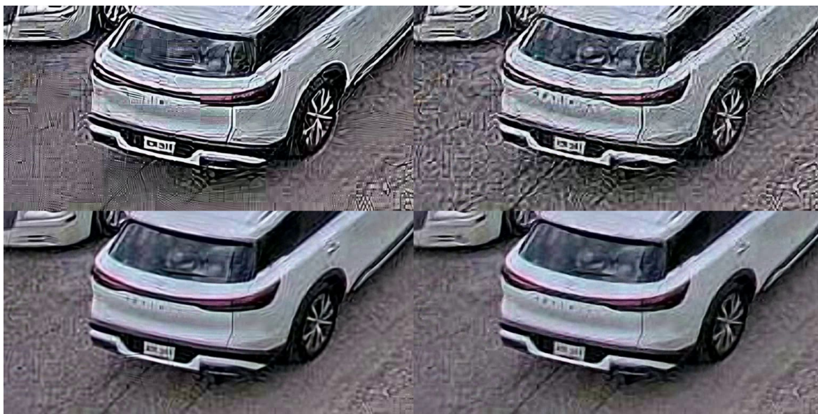
Obr. 3.19: Vľavo hore: zaostrovanie hranovým filtrom + EDSR, vpravo hore: zaostrovanie hranovým filtrom + ESPCN, vľavo dole: zaostrovanie odčítaním rozmazaného obrazu + EDSR, vpravo dole: zaostrovanie odčítaním rozmazaného obrazu + ESPCN
