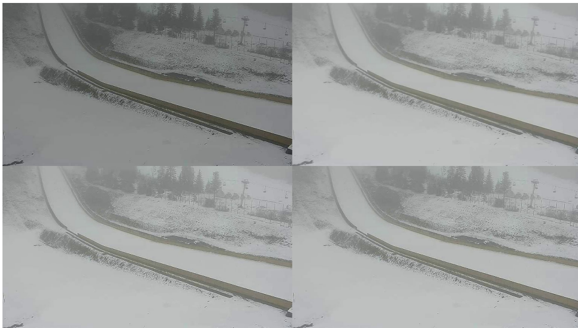
Obr. 3.29: Vľavo hore: zaostrenie hranovým filtrom, vpravo hore: zosvetlenie o hodnotu 50 (v každej RGB zložke), vľavo dole: zaostrenie hranovým filtrom + zosvetlenie, vpravo dole: zosvetlenie + zaostrenie hranovým filtrom
