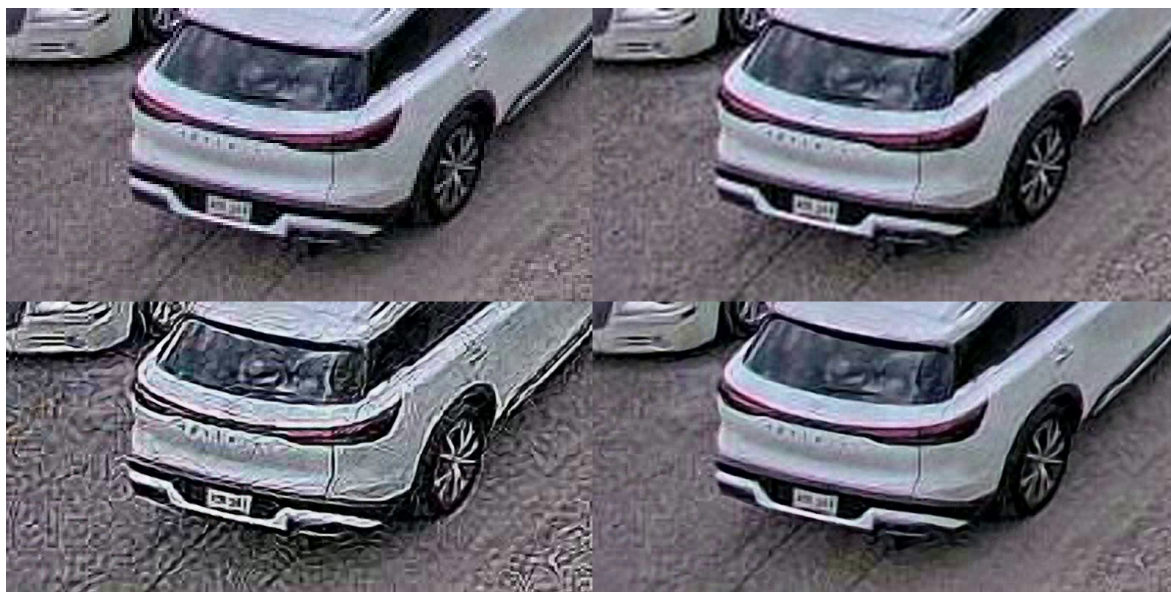
Obr. 3.22: Vľavo hore: záber v pôvodnom rozlíšení, vpravo hore: štvornásobné zväčšenie bikubickou interpoláciou, vľavo dole: zaostrovanie hranovým filtrom + ESPCN, vpravo dole: zaostrovanie odčítaním rozmazaného obrazu + ESPCN
