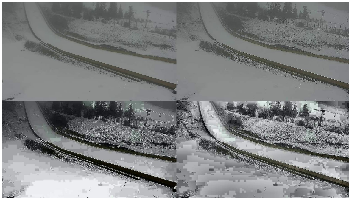
Obr. 3.30: Vľavo hore: pôvodný záber, vpravo hore: zaostrenie hranovým filtrom, vľavo dole: zaostrenie hranovým filtrom + ekvalizácia histogramu, vpravo dole: + zaostrenie hranovým filtrom + adaptívna ekvalizácia histogramu
