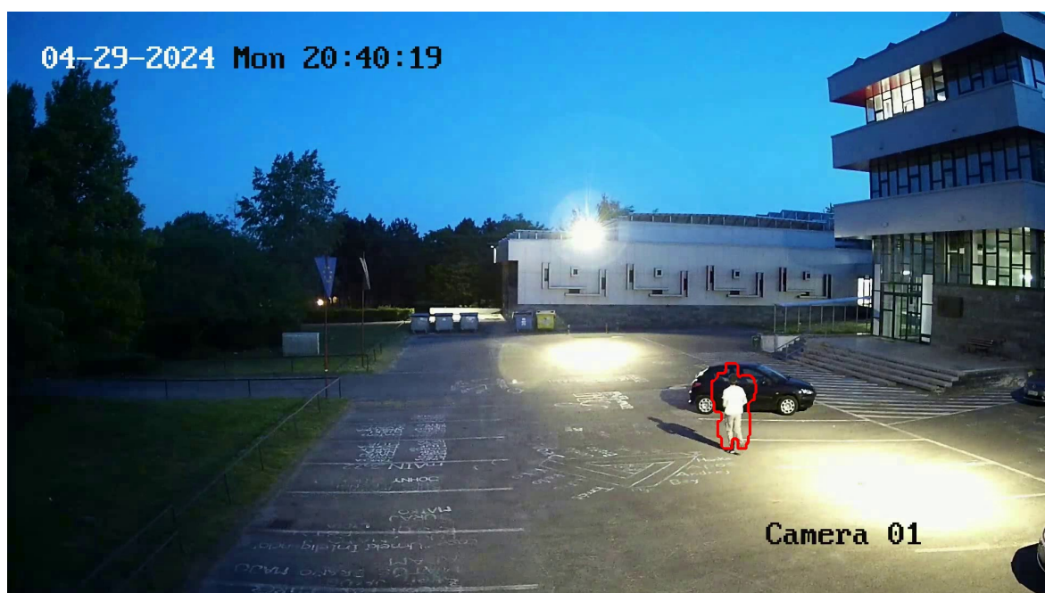
Obr. 3.16: Približné označenie siluety pohybujúcej sa osoby získané z infračerveného záberu automaticky vygenerované nami zostrojenou metódou track_movement_thermo_to_rgb .
