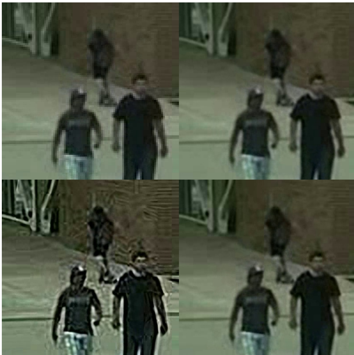
Obr. 3.3: Vľavo hore: originálny záber v pôvodnom rozlíšení, vpravo hore: 4-násobné zvýšenie rozlíšenia EDSR, vľavo dole: zaostrenie hranovým filtrom a následné 4-násobné zvýšenie rozlíšenia EDSR, vpravo dole: zaostrenie odčítaním rozmazaného obrazu a následné 4-násobné zvýšenie rozlíšenia EDSR
