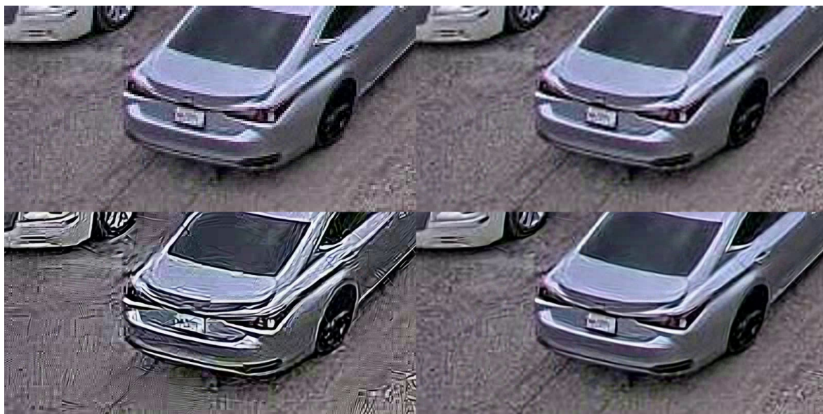
Obr. 3.21: Vľavo hore: záber v pôvodnom rozlíšení, vpravo hore: štvornásobné zväčšenie bikubickou interpoláciou, vľavo dole: zaostrovanie hranovým filtrom + EDSR, vpravo dole: zaostrovanie odčítaním rozmazaného obrazu + EDSR
