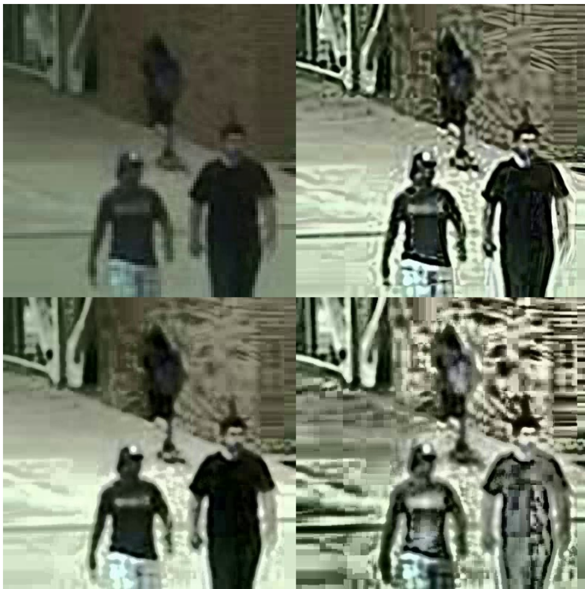
Obr. 3.4: Vľavo hore: originálny záber v pôvodnom rozlíšení, vpravo hore: zaostrenie hranovým filtrom, následné 4-násobné zvýšenie rolíšenia EDSR a ekvalizácia histogramu na záver, vľavo dole: zaostrenie odčítaním rozmazaného obrazu, následné 4-násobné zvýšenie rolíšenia EDSR a ekvalizácia histogramu na záver, vpravo dole: zaostrenie odčítaním rozmazaného obrazu, následné 4-násobné zvýšenie rolíšenia EDSR a adaptívna ekvalizácia histogramu na záver s okolím 4 pixelov a jeho limitom kontrastu 20
