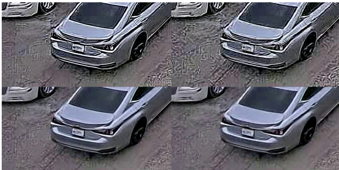
Obr. 3.20: Vľavo hore: odstránenie šumu nelokálnym priemerovaním + zaostrovanie hranovým filtrom + EDSR, vpravo hore: odstránenie šumu nelokálnym priemerovaním + zaostrovanie hranovým filtrom + ESPCN, vľavo dole: odstránenie šumu nelokálnym priemerovaním + zaostrovanie odčítaním rozmazaného obrazu + EDSR, vpravo dole: odstránenie šumu nelokálnym priemerovaním + zaostrovanie odčítaním rozmazaného obrazu + ESPCN
