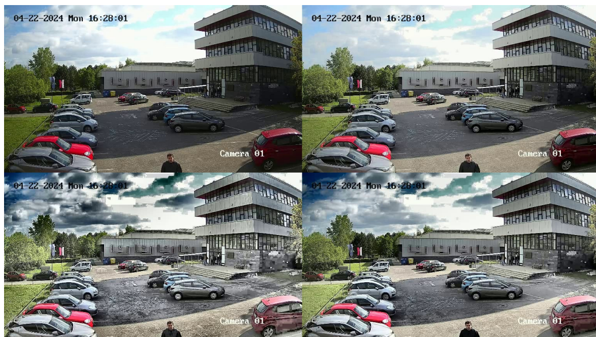
Obr. 3.1: Vľavo hore: originálny záber, vpravo hore: ekvalizácia histogramu (v YCbCr formáte), vľavo dole: adaptívna ekvalizácia histogramu s okolím 8 pixelov a jeho limitom kontrastu 40, vpravo dole: adaptívna ekvalizácia histogramu s okolím 4 pixelov a jeho limitom kontrastu 20
