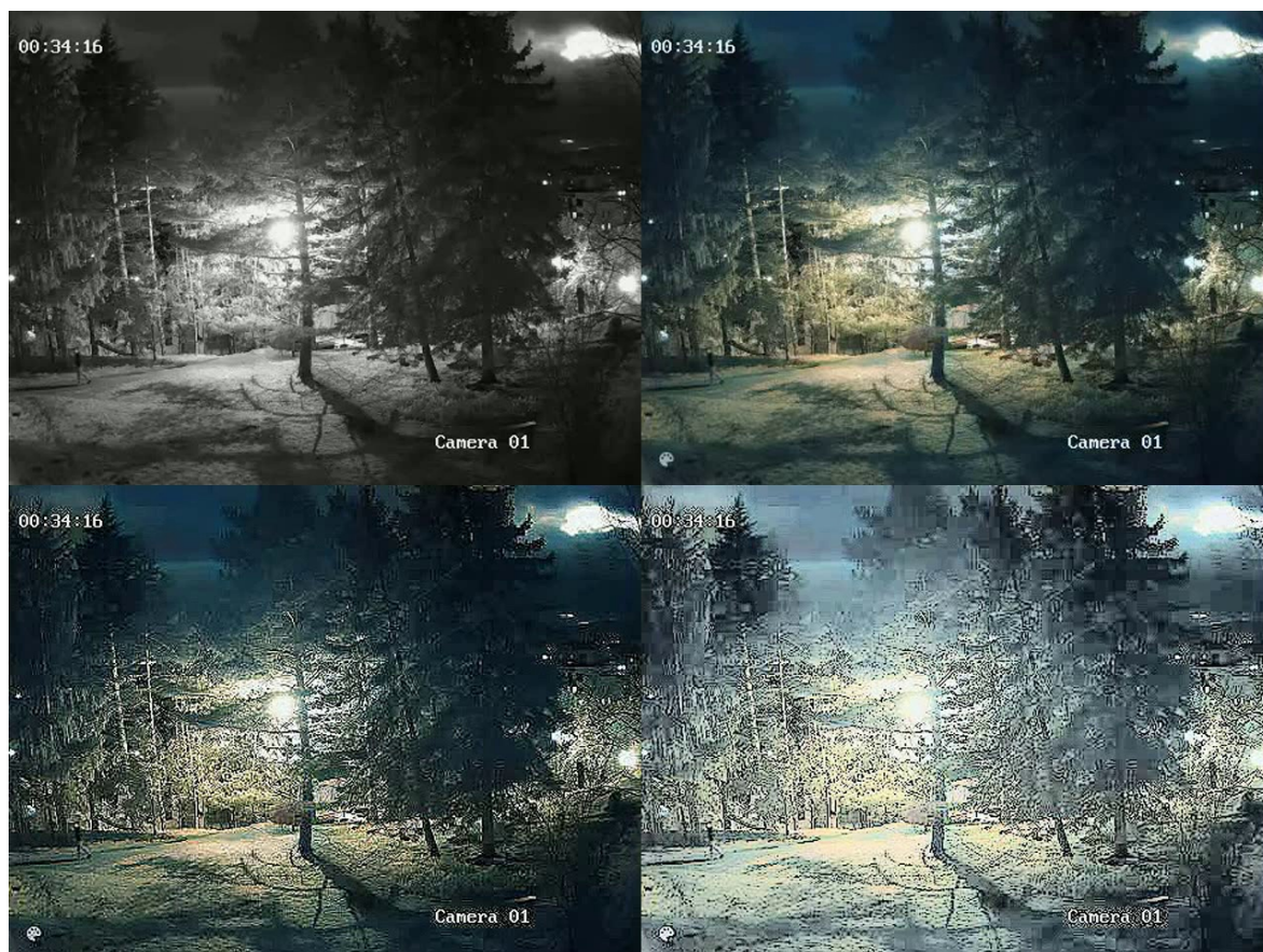
Obr. 3.9: Vľavo hore: originálny záznam, vpravo hore: rekolorizácia, vľavo dole: rekolorizácia + zaostrenie hranovým filtrom, vpravo dole: rekolorizácia + zaostrenie hranovým filtrom + ekvalizácia histogramu
