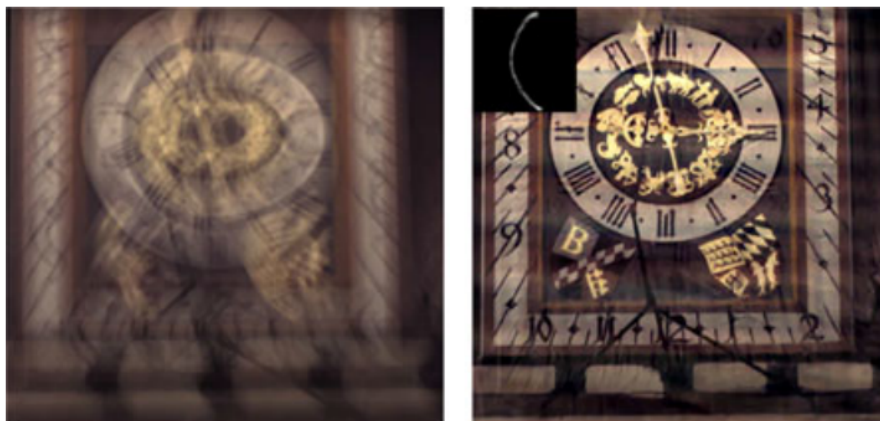
Obr. 1.3: Výsledok (napravo) aplikácie prístupu [3] na rozmazaný záber (naľavo)
