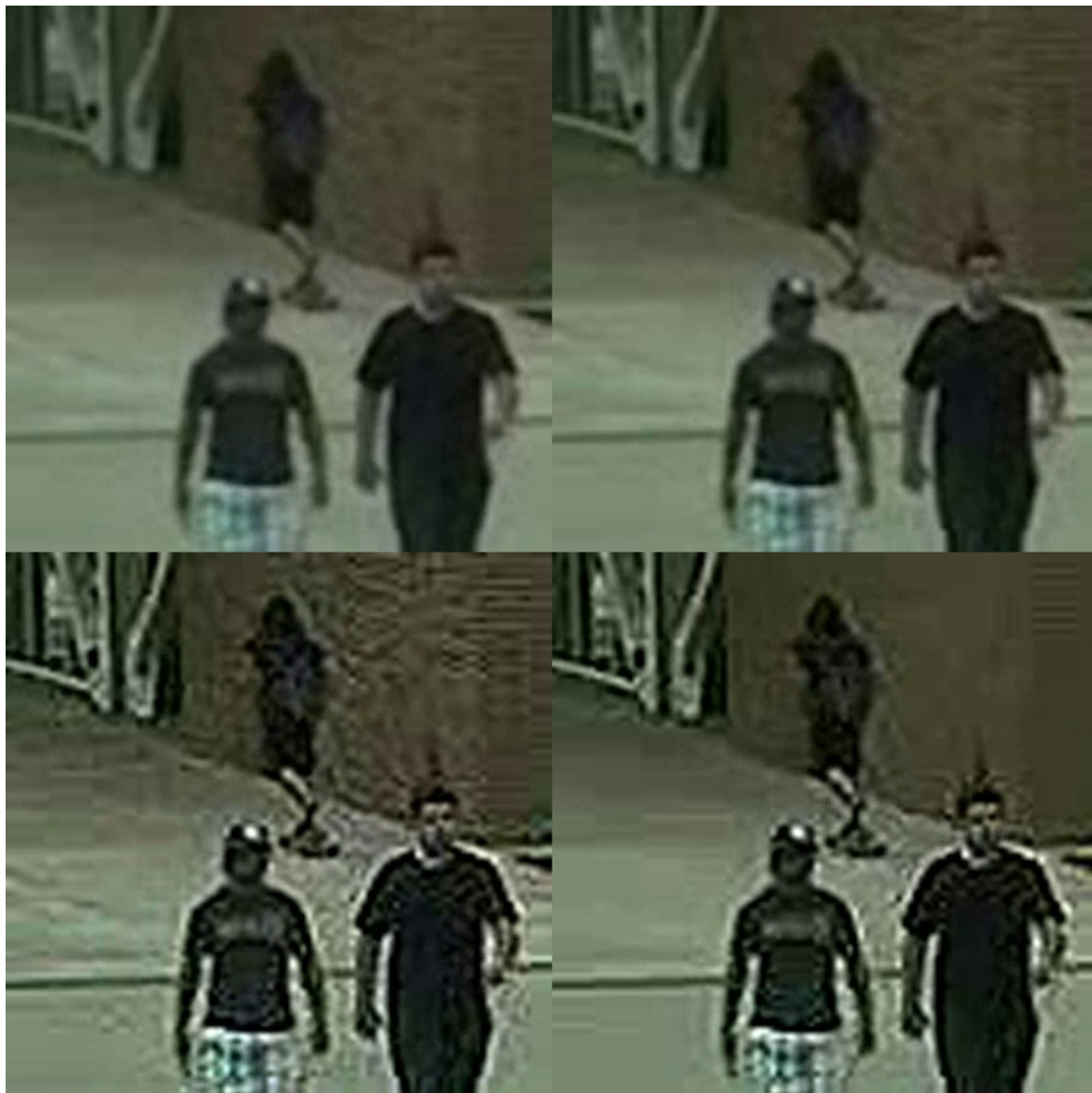
Obr. 3.2: Vľavo hore: originálny záber, vpravo hore: zaostrenie odčítaním rozmazaného obrazu, vľavo dole: zaostrenie hranovým filtrom, vpravo dole: odstránenie šumu a následné zaostrenie hranovým filtrom
